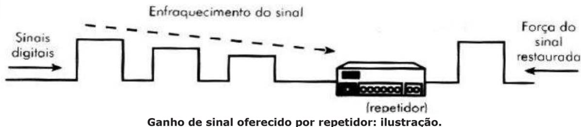
**Hubs** – antes dos roteadores domésticos, eram utilizados hubs. O hub é um repetidor local, sem amplificação do sinal (camada 1 do OSI). Funciona como um ponto concentrador de conexões.
