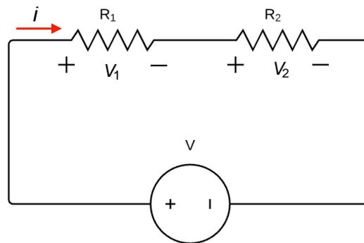
Figura 3-Circuito divisor de tensão.
