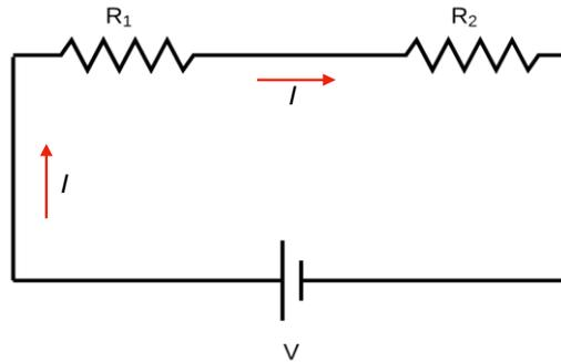
Figura 1-Resistores em série compartilhando a mesma corrente.
