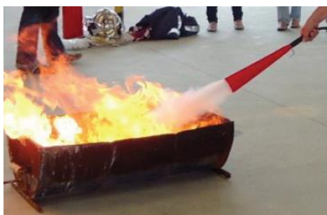
Figura 1.9: Extinção química com extintor halon ou CFC.
