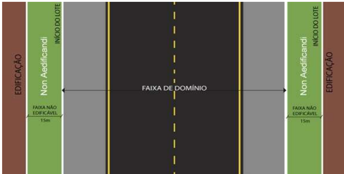
Figura 10 - Partes componentes de uma rodovia
