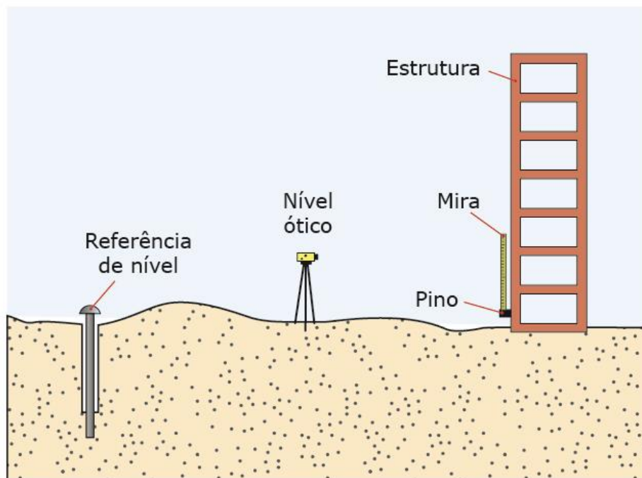
Figura 38: nível ótico com mira para medição da estrutura
