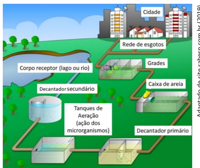
Estação de Tratamento de Esgotos.
