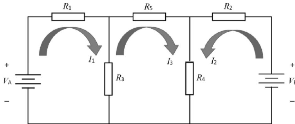
$$V_A + V_B = R_1 I_1 + R_5 I_3 - R_2 I_2$$
