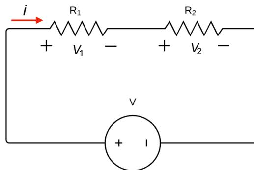
Figura 7-Circuito divisor de tensão.
