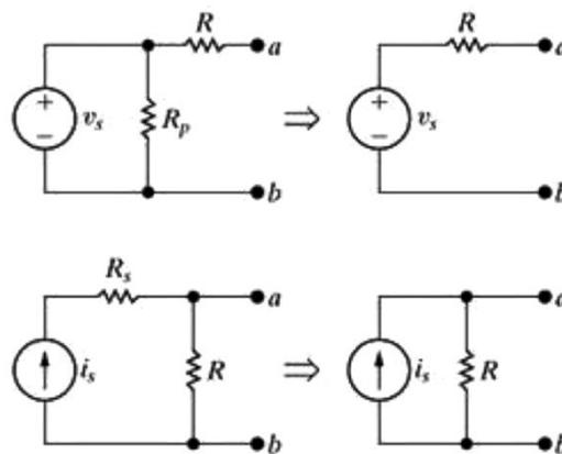
Figura 24-Efeito de uma resistência sobre o circuito equivalente.
