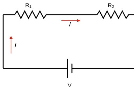
Figura 5-Resistores em série compartilhando a mesma corrente.
