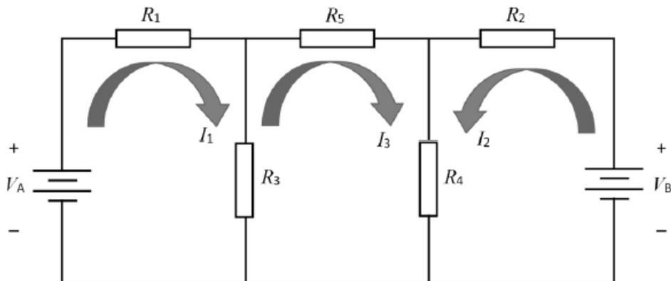
63-Caso se desejasse obter o circuito equivalente de Thévenin a partir dos terminais de  $R_4$ , a resistência equivalente de Thévenin seria igual.
