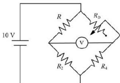
Quando o circuito da ponte de Wheatstone estiver em equilíbrio, o voltímetro aferirá 0 V.
