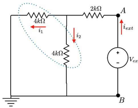
Agora ficou mais fácil simplificar a configuração atual do circuito, pois os resistores de  $4k\Omega$  estão em paralelo resultando em um resistor equivalente de  $2k\Omega$ .
