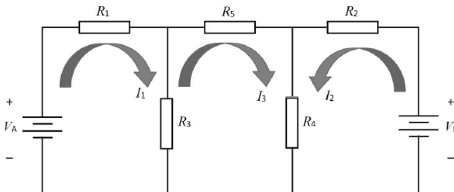
Caso se desejasse obter o circuito equivalente de Thévenin a partir dos terminais de R<sub>4</sub>, a resistência equivalente de Thévenin seria igual
