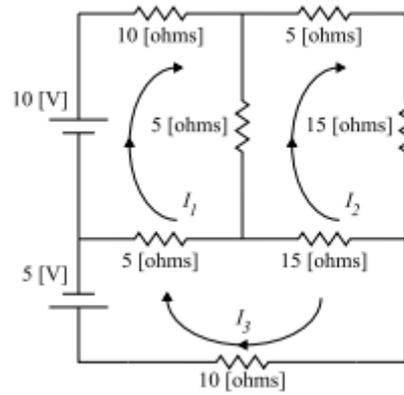
$$(A) \begin{bmatrix} 20 & -5 & -5 \\ -5 & 40 & -15 \\ -5 & -15 & 30 \end{bmatrix} \times \begin{bmatrix} I_1 \\ I_2 \\ I_3 \end{bmatrix} = \begin{bmatrix} 10 \\ 0 \\ 5 \end{bmatrix}$$
