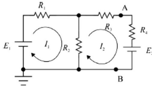
Considere que todos os componentes do circuito sejam ideais e que  $E_1 = 10V$ ,  $E_2 = 2V$ ,  $R_1 = R_2 = 4k\Omega$ ,  $R_3 = R_4 = 2k\Omega$ .
