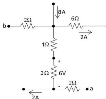
A diferença de potencial  $V_{ab}$  desse circuito, em volts, é igual a
