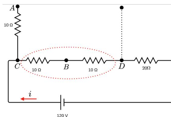
Seguindo nas simplificações, observamos os resistores de  $10\Omega$  em série resultando em um equivalente de  $20\Omega$ .
