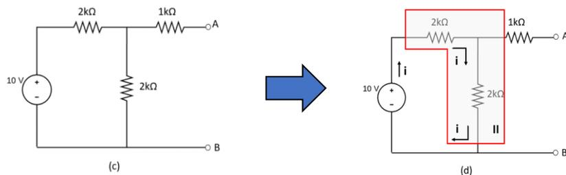
Como os terminais A e B estão abertos a corrente fornecida pela fonte circula apenas através dos resistores do bloco II (figura (d)). Calculando o resistor equivalente do bloco II e aplicando a lei de ohm ao circuito da figura (d), encontramos a corrente  $i$  que percorre o circuito:
