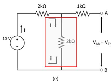
Aplicando novamente a lei de ohm para o resistor de 2kΩ assinalado na figura (e), podemos determinar a tensão entre os terminais A e B:
