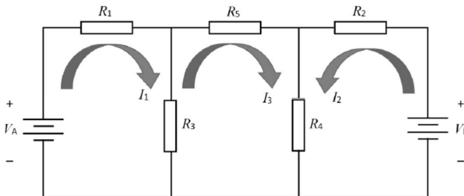
$$61-V_A + V_B = R_1 I_1 + R_5 I_3 - R_2 I_2$$
