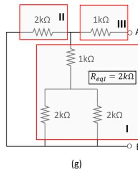
O resistor equivalente do bloco I (já foi calculado no item anterior), está em paralelo com o resistor de 2kΩ (bloco II), cujo resistor equivalente resultante está em série com o resistor de 1kΩ (bloco III). Aplicando a lei de ohm para essa associação de resistores, podemos determinar a resistência equivalente entre os pontos A e B:
