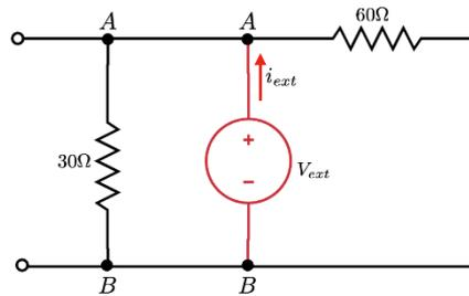
Com a nova configuração do circuito fica fácil visualizar que os resistores de  $30\Omega$  e  $60\Omega$  estão em paralelo.
