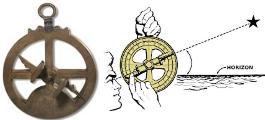
Figura 09 – Desenho e esquema de um astrolábio
