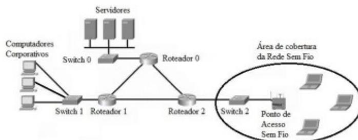
O diagrama lógico precedente ilustra uma rede cujos roteadores estão conectados via cabo metálico, com velocidade de transmissão de dados igual a 1 Gbps, e funcionam no nível de rede do modelo OSI. Os serviços de rede (DNS, FTP, SSH, SMTP, POP, IMAP, HTTP, HTTPS, SSL, RDP, DHCP) funcionam nos servidores conectados ao Switch 0 e o Ponto de Acesso Sem Fio fornece segurança para os dispositivos que se conectarem de forma sem fio.
