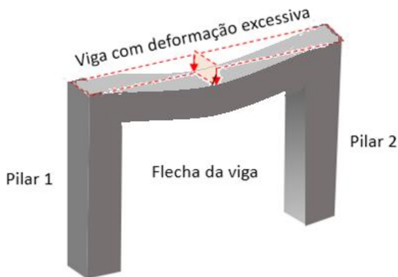
Figura 14: viga com deformação excessiva vertical ao centro mostrada pelas setas (essa deformação vertical no centro da viga é chamada de flecha da viga)
