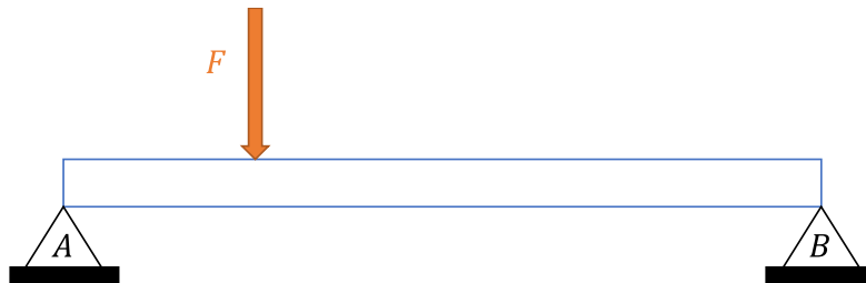
Viga biapoiada com carga concentrada
