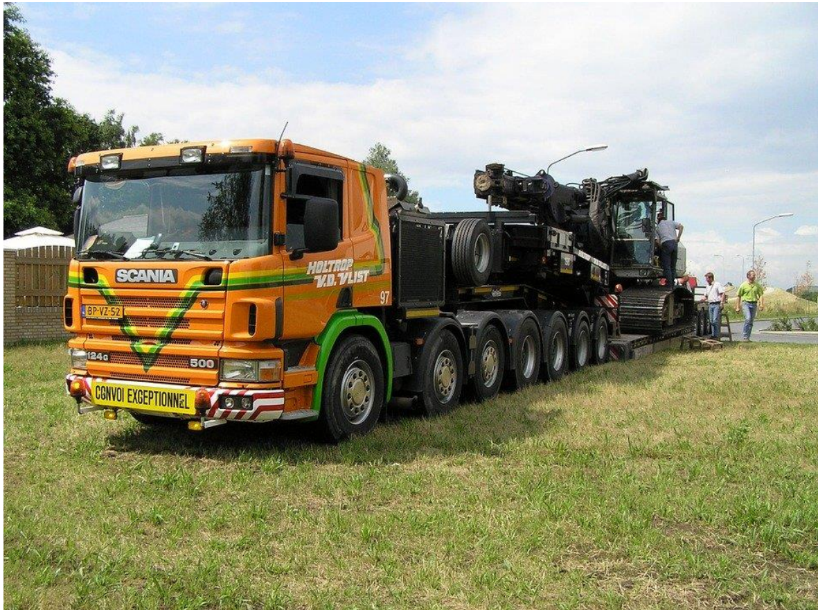
Figura 4: exemplo de carreta utilizada na mobilização de máquinas em uma obra
