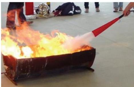
Figura: Extinção química com extintor halon ou CFC.
