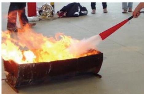
**Figura 1.9:** Extinção química com extintor halon ou CFC.
