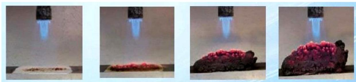
**Figura 1.10<sup>16</sup>:** Ação da tinta intumescente quanto exposta ao fogo.
