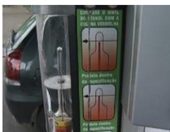
Figura 4 – densímetros de postos combustíveis. [Fonte: Globo]
