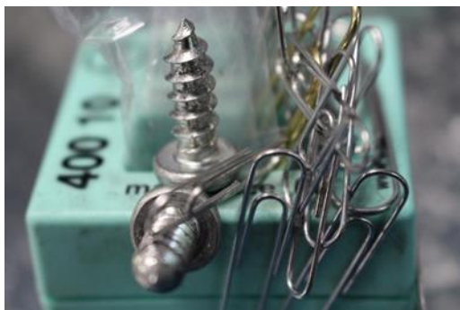
Figura 18 - Materiais de aço sendo atraídos por ímãs. [Fonte: pixabay.com]
