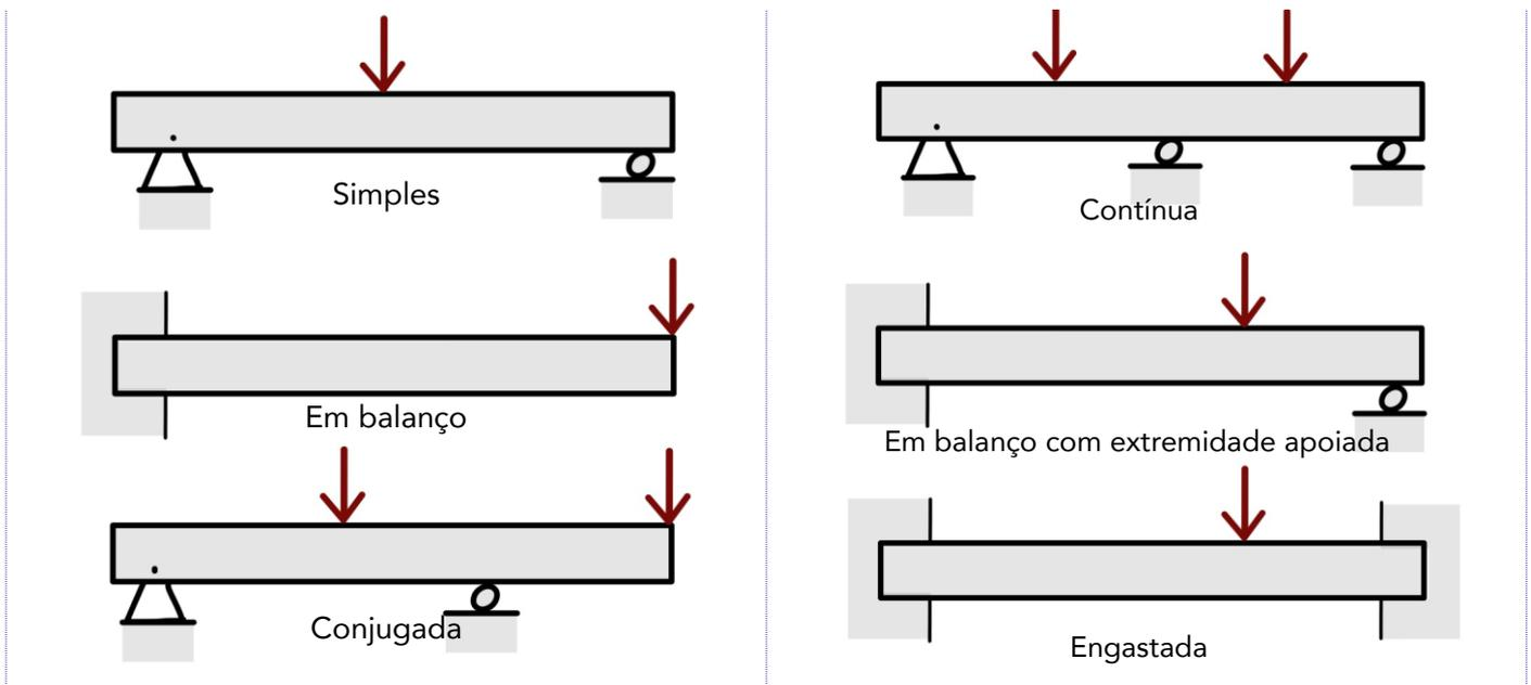
Basicamente, as vigas que se encontram apoiadas, de maneira que podemos calcular as reações aos seus apoios externos aplicando somente os métodos da estática (equações de equilíbrio), são chamadas de vigas estaticamente determinadas. Vigas que possuem mais pontos de apoios do que o necessário para que estejam em equilíbrio, são denominadas estaticamente indeterminadas (possuem maior número de reações de apoios do que equações de equilíbrio).
