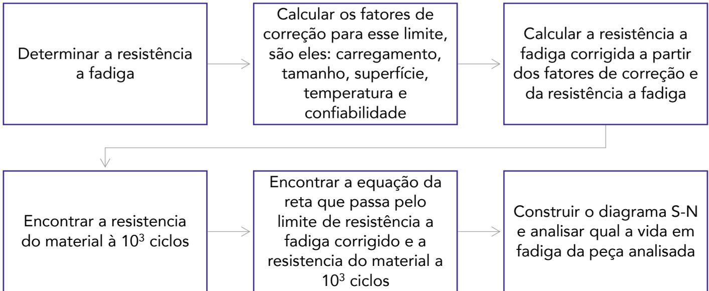
Caso a peça apresente tensões de trabalho abaixo do limite de resistência a fadiga corrigido ( $S_e$ ), a vida infinita será alcançada.
