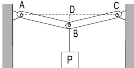
Essas barras são rotuladas no ponto  $B$  e têm as outras extremidades presas às rótulas  $A$  e  $C$ , ambas localizadas na mesma linha horizontal  $AC$ . A linha vertical  $BD$  é 20 vezes menor que os comprimentos  $AB$  e  $BC$  ( $BD=AB/20$ ,  $AB=BC$ ). As tensões (forças de tração) nas barras  $AB$  e  $BC$  para que o peso  $P$  seja suportado são expressas por:
