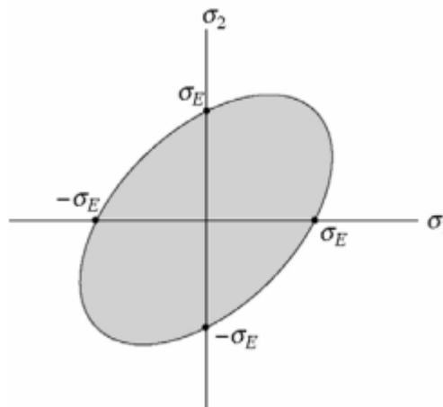
Quando um ponto do material estiver tracionado de maneira que a coordenada da tensão ( $\sigma_1, \sigma_2$ ) esteja posicionada no limite ou fora da área sombreada, diz-se que o material falhou.
