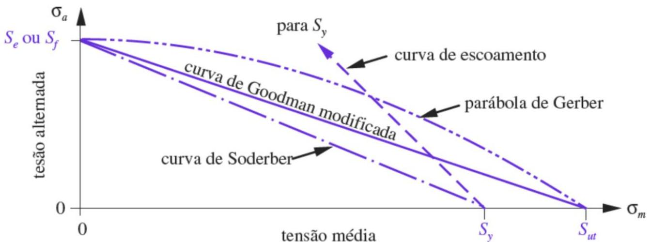
O gráfico das curvas de critério de falha por fadiga, é montado utilizando dois eixos de tensão. O eixo horizontal corresponde à tensão média, enquanto o eixo vertical corresponde à tensão alternada. Por isso **para casos em que a tensão varia em tração e compressão com a mesma intensidade, devemos utilizar a curva de Wöhler para determinar o comportamento do material sob uso em fadiga.**
