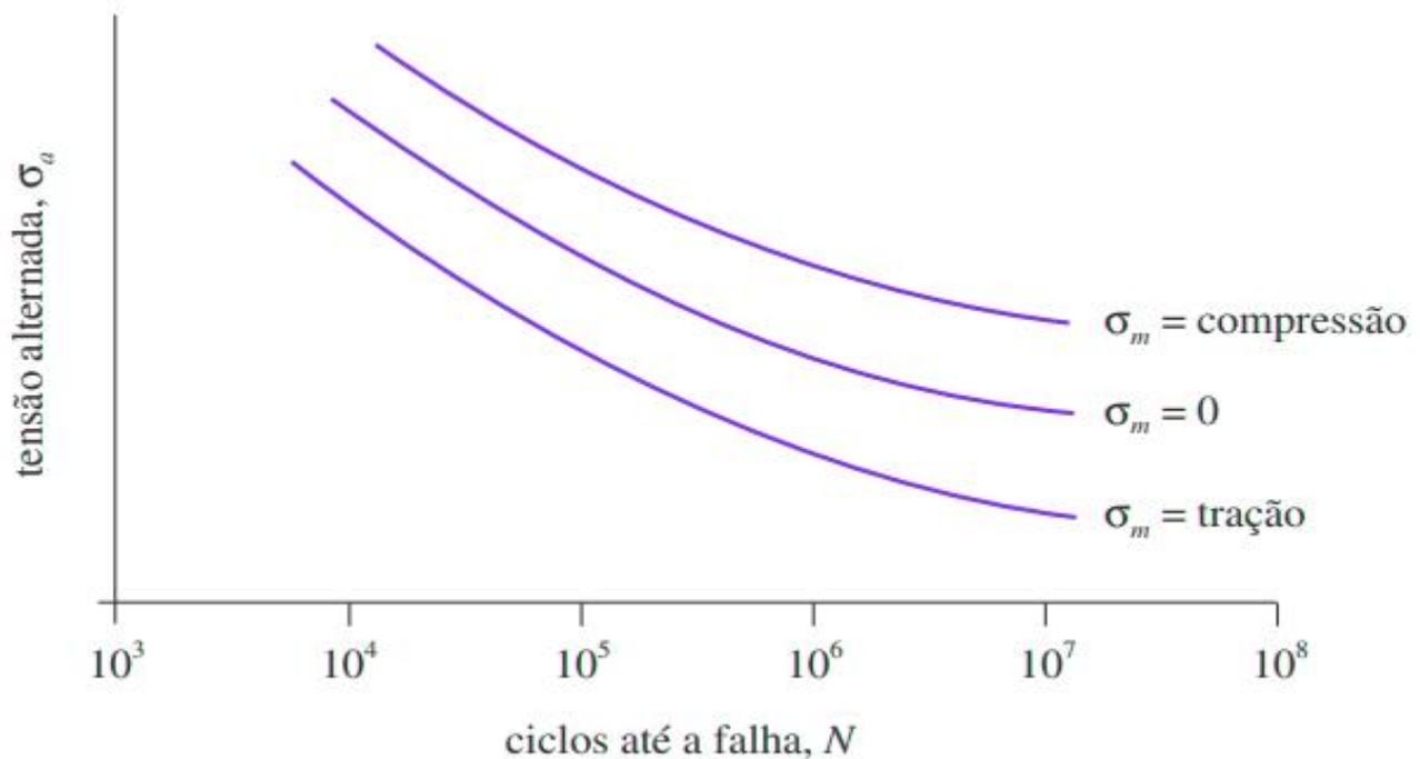
Por esse motivo, em algumas peças, essas tensões são introduzidas propositalmente através de tratamentos térmicos, tratamentos superficiais e tratamentos mecânicos de pré-tensionamento. Esses processos criam estados de tensões biaxiais de compressão na superfície e triaxiais de compressão abaixo da superfície. No centro da peça, estados triaxiais de tração aparecem.
