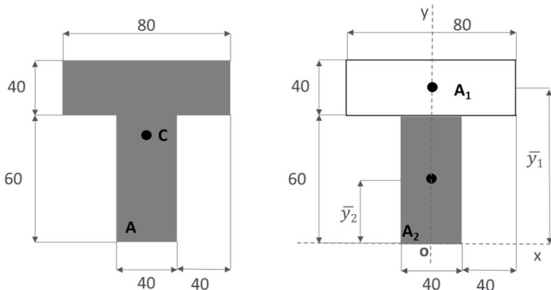
Para determinarmos o **centroide** da área indicada, devemos adotar o **eixo de coordenadas** e dividi-la em dois retângulos. Conforme a figura ao lado.
