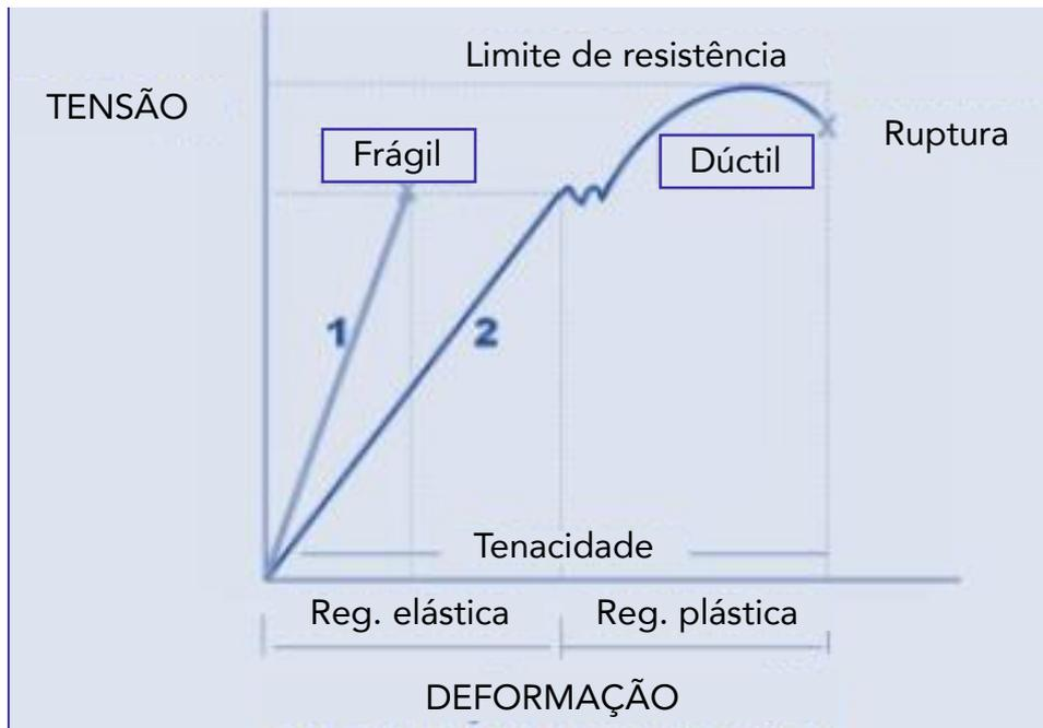
Note que os materiais frágeis são materiais que apresentam pequena ou nenhuma deformação antes de sua ruptura. Diferentemente dos materiais dúcteis os materiais frágeis respondem de maneira diferente para tensões de tração e compressão, sendo que geralmente eles resistem melhor a compressão.
