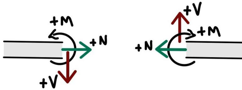
Além do momento fletor e da força de cisalhante, um corpo está sujeito a **força normal N**, que age perpendicularmente à área conforme a figura acima.
