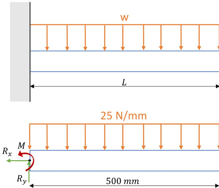
A **força resultante da concentração** de uma força distribuída em uma viga sempre estará localizada no **centróide** da área em consideração. Neste caso temos um retângulo que possui seu centroide no centro de seu comprimento que é 250 mm. Além disso, a resultante é igual a carga distribuída multiplicada pelo seu comprimento. Vejamos:
