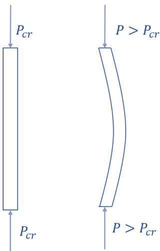
A **carga axial máxima** que uma coluna pode suportar antes de sofrer uma deformação é denominada **carga crítica ( $P_{cr}$ )**. Sendo assim se uma carga maior do que está for aplicada ocorrerá flambagem.
