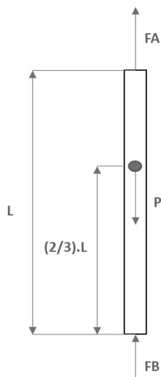
A partir da análise de compatibilidade de deformação nos apoios, o deslocamento entre uma extremidade da barra seria igual ao da outra, que seria igual a zero, devido a fixação em ambos os apoios da barra. Assim obtemos:
