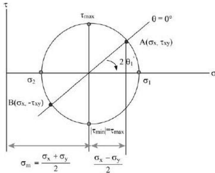
A figura precedente ilustra o círculo de tensões de Mohr, em que a ordenada de um ponto sobre o círculo representa a tensão de cisalhamento ( $\tau$ ) e a abcissa representa a tensão normal ( $\sigma$ ).
