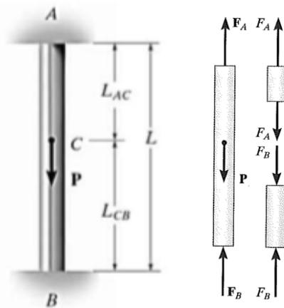
Vamos exemplificar o princípio da superposição com um exemplo em que um elemento estaticamente indeterminado carregado com uma carga axial. Nesse caso, a barra está presa em ambas as extremidades se tornando indeterminada, pois não é possível a determinação de suas reações através dos princípios de equilíbrio. Vejamos o DCL, ao lado, e a análise de equilíbrio:
