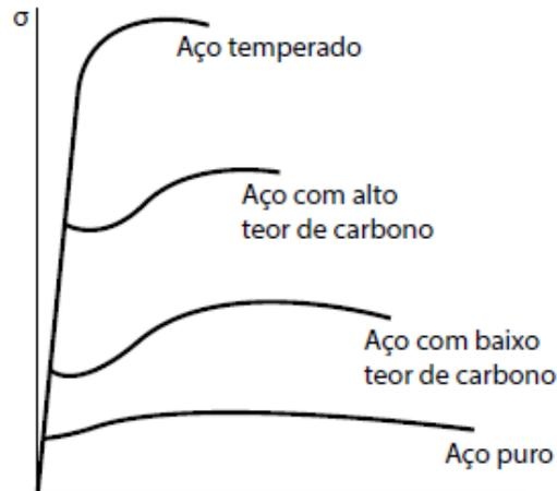
Diagrama de Tensão-deformação específica para quatro tipos diferentes de aço (Beer & Johnston, 2006)
