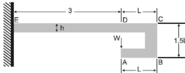
A figura acima mostra uma viga de seção retangular constante de altura  $h$  e momento de inércia  $I$ , submetida a um carregamento  $W$  aplicado no ponto A. Considerando essas informações julgue o item a seguir.
