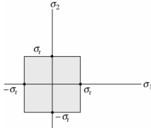
Nota-se que se a coordenada da tensão principal ( $\sigma_1 \sigma_2$ ) em um ponto do material encontrar-se no limite ou fora da área sombreada, diz-se que o material sofrerá fratura. Essa teoria útil para materiais frágeis cujos diagramas tensão-deformação são iguais tanto sob tração quanto sobre compressão.
