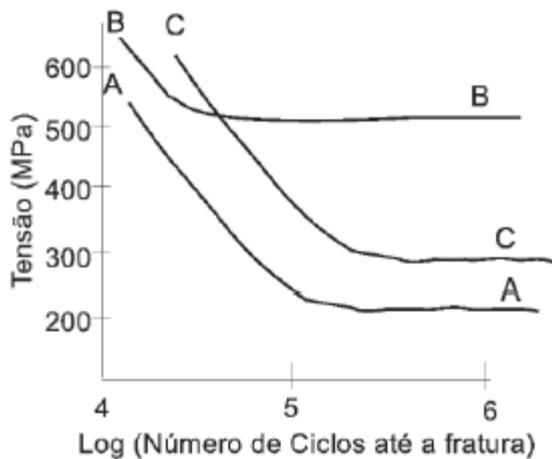
Um determinado eixo sofrerá um carregamento cíclico dado pela expressão:  $S(t) = 300 + 150 \sin(2\pi vt)$  MPa, onde  $v$  é a frequência de rotação do eixo.
