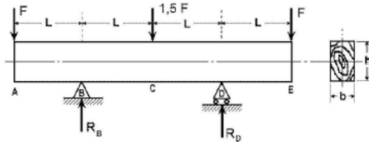
O carregamento mostrado na figura acima consiste em uma viga de madeira biapoiada, de área de secção  $h \times b$  e comprimento  $4L$ . Com relação a essa viga, julgue o item seguinte.
