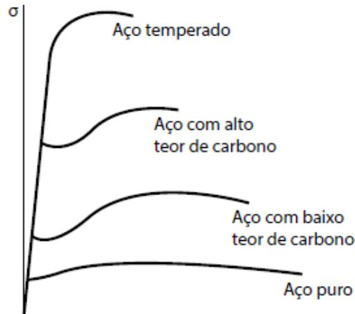
*Diagrama de Tensão-deformação específica para quatro tipos diferentes de aço (Beer & Johnston, 2006)*
