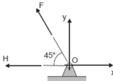
No ponto O atuam as forças  $F=20\sqrt{2}\text{N}$  e  $H=10\text{N}$ . A projeção da resultante destas forças nos eixos x e y, segundo a orientação estabelecida para os eixos x e y, respectivamente, é
