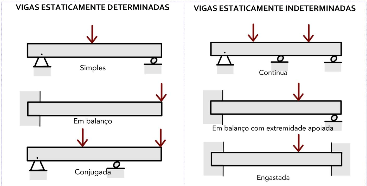
Podemos também identificar as vigas pelos **tipos de carregamentos externos** qual estão expostas. Estas podem sofrer cargas concentradas, como vistas na figura acima ou distribuídas, conforme a figura abaixo.
