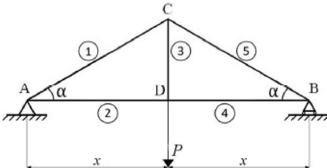
A figura precedente ilustra uma treliça, composta pelas barras retas numeradas de 1 a 5 e ligadas nos quatro nós A, B, C e D; em A, há um apoio fixo, e em B, há um apoio móvel. Na figura,  $P = 10 \text{ kN}$ ,  $x = 10 \text{ m}$  e  $\alpha = 30^\circ$ .
