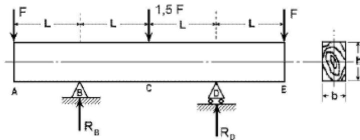
O carregamento mostrado na figura acima consiste em uma viga de madeira biapoiada, de área de seção  $h \times b$  e comprimento  $4L$ . Com relação a essa viga, julgue o item seguinte.
