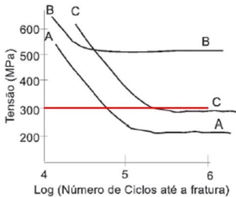
Aprendemos em aula que a falha por fadiga ocorre quando a linha do gráfico é cruzada, por este motivo concluímos que o material B nunca falhará por fadiga com a aplicação desses esforços. O material A tem a sua linha cortada antes do material C, podemos constatar então que ambos vão falhar, porém a falha do material A antecede a falha do material C.
