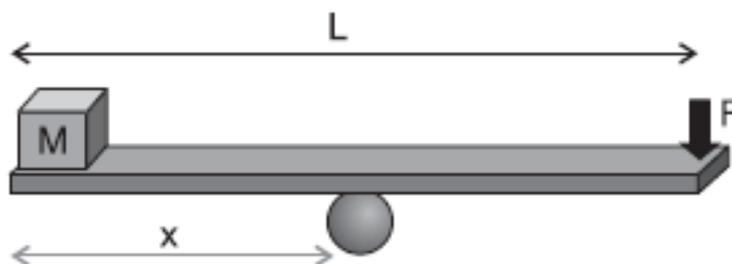
Uma prancha de madeira de massa desprezível e comprimento  $L = 2,8 \text{ m}$  é utilizada para manter em equilíbrio, na horizontal, um cubo pequeno de massa 20,0 kg ao realizar uma força  $F$  de 80,0 N em uma das extremidades da prancha.
