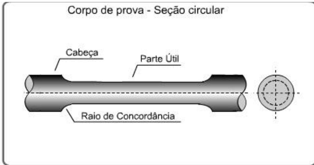
A Parte útil é a porção efetivamente utilizada para medição do alongamento.
