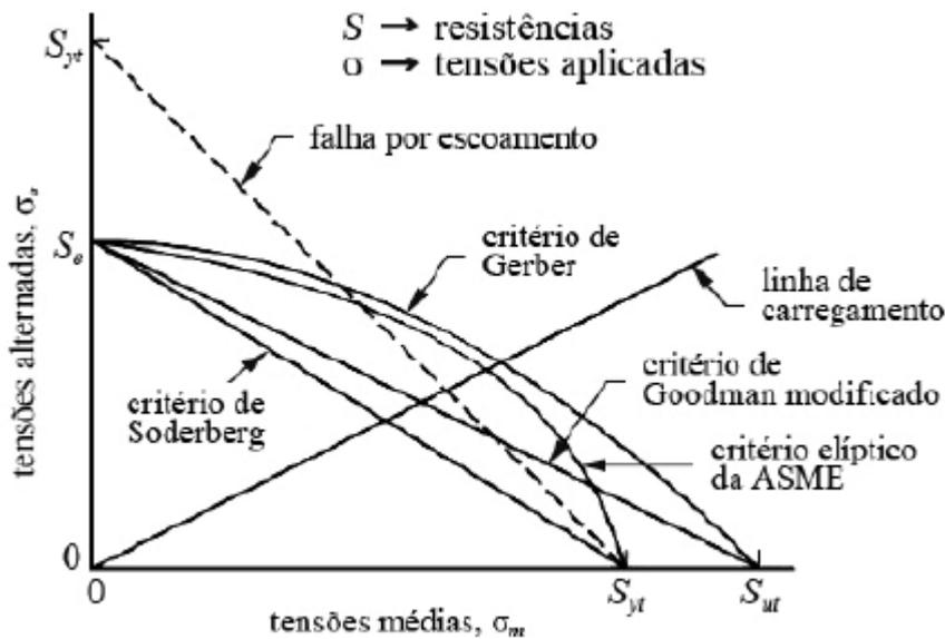
A figura precedente mostra vários critérios de falha por fadiga utilizados no dimensionamento de elementos de máquinas sob cargas variáveis.
