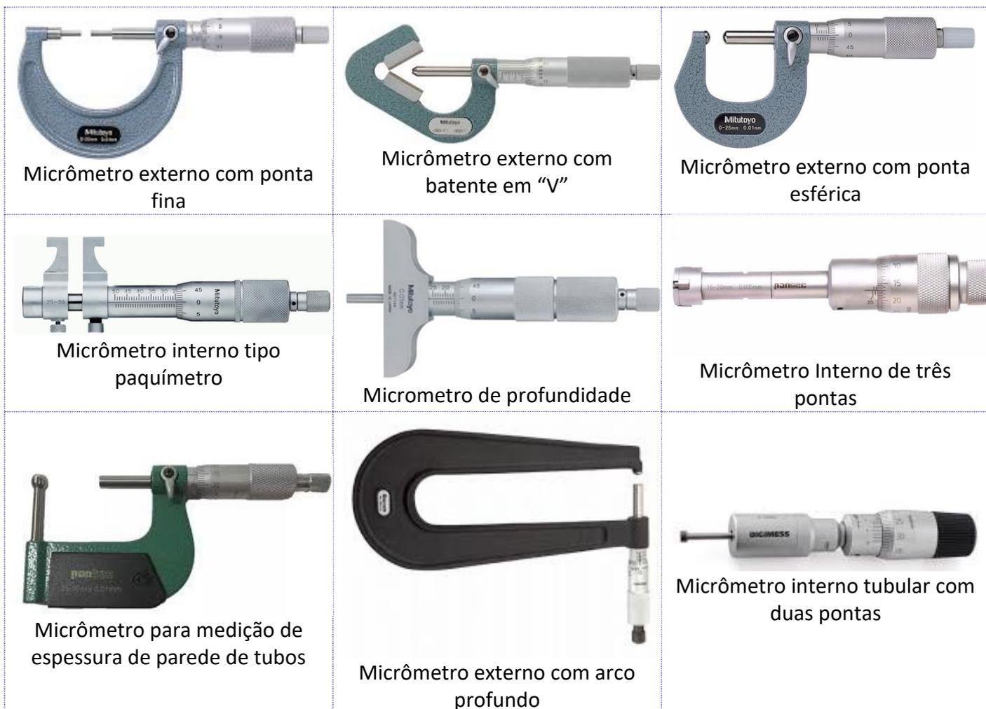
Na imagem acima temos representados os principais tipos de micrômetros utilizados atualmente. Existem também variações de modelos conforme melhorias são criadas.
