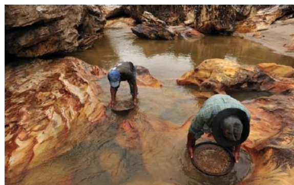
Figura 14 - Utiliza o da bateia em garimpos. [Fonte: Circuitomt.com.br], [Fonte: Circuito MT]
