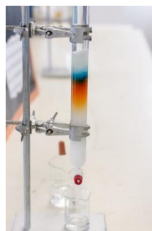
Figura 28 - cromatografia em coluna [Fonte: SHUTTERSTOCK].
