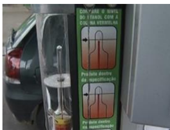
Figura 4 – densímetros de postos combustíveis. [Fonte: Globo]
