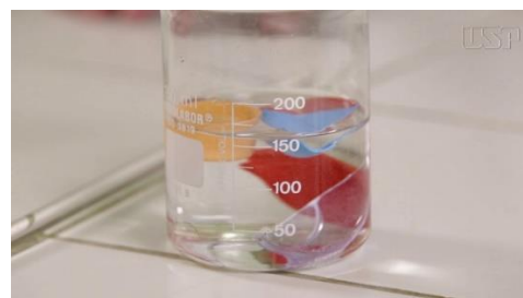
Figura 24 - flotação utilizada para separar plásticos de densidades distintas. [Fonte: EAulas.USP]
