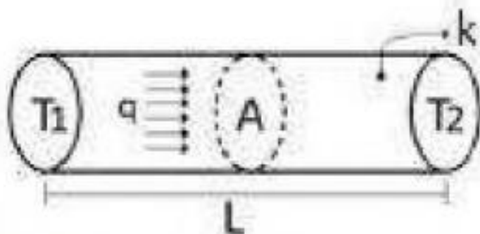
Figura 3 – Esquema da transferência de calor por condução em uma barra
