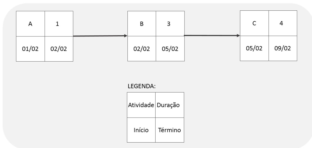
Figura 18: método dos blocos. Observe que os blocos são representados por letras, pois também indicam as atividades, que, por convenção, são indicadas por letras
