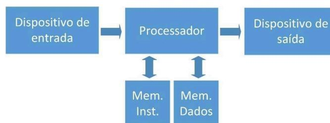
Com essa separação de dados e instruções em memórias e barramentos separados, o processador consegue acessar as duas simultaneamente, obtendo um desempenho melhor do
