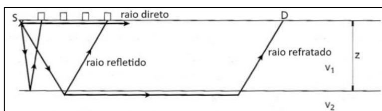
Figura 23 - Representação das trajetórias percorridas pelos diferentes raios de onda. Fonte Modificado de Kearey et al (2009) 30
