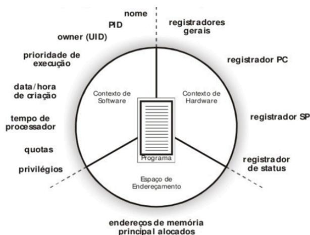
O **PID** (Process Id) é o número de identificação de um processo, atribuído na ordem em que são criados. O **PPID** é o PID do processo pai. **Não há chamada de sistema que crie um processo** no Linux, o que acontece é que um **processo existente realiza seu clone - chamada de sistema fork()** - e o processo clone pode trocar o programa por um diferente. O original é o pai e a cópia gerada é o filho.
