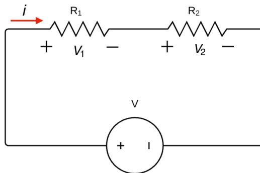
Figura 7-Circuito divisor de tensão.
