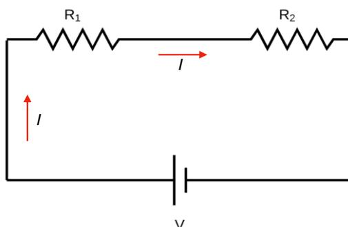
Figura 5-Resistores em série compartilhando a mesma corrente.
