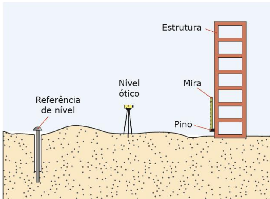
Figura 45: Nível ótico com mira para medição da estrutura
