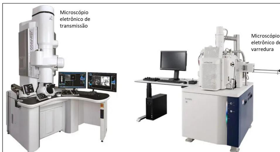
No MET, a amostra é cortada em fatias extremamente finas antes da visualização, e o feixe de elétron atravessa a fatia ao invés de percorrer sobre sua superfície, resultando em imagens detalhadas das estruturas internas da amostra. No MEV, um feixe de elétrons move-se para a frente e para trás através da superfície de uma célula ou tecido, criando uma imagem detalhada da superfície 3D.
