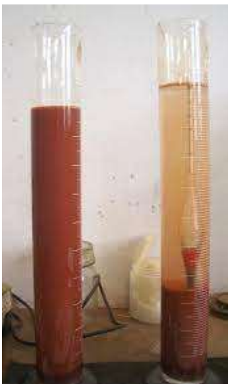
Figura 16 - Proveta com solução contendo fração fina do solo
