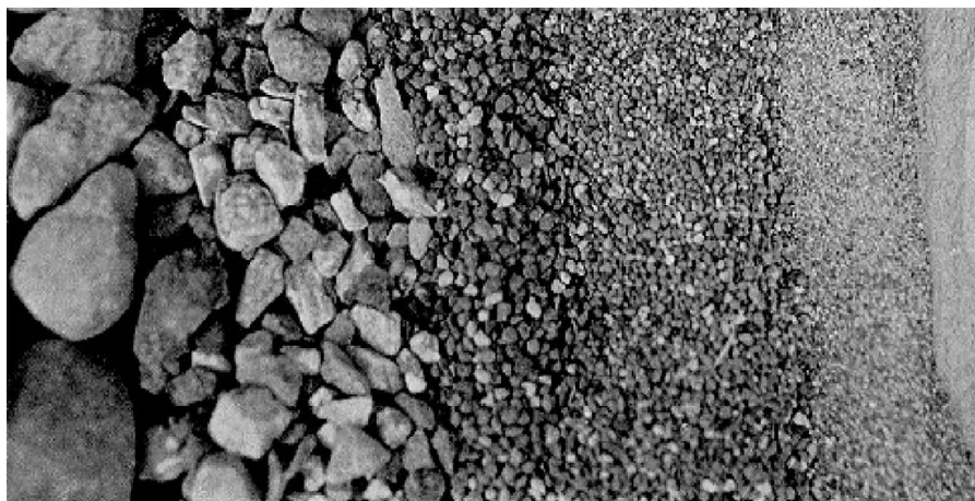
Figura 14: Grãos de amostra de solo segregado por dimensão
