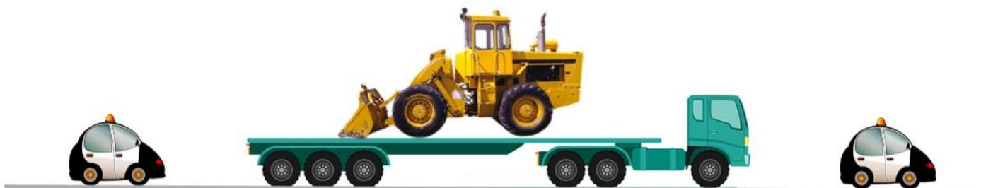
Figura 5: mobilização e desmobilização é um custo significativo no caso de obras rodoviárias, sendo uma estratégia utilizada pelas construtoras para otimização do aproveitamento de seus equipamentos
