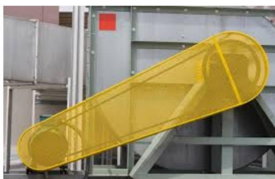
Figura 1.2: Sistema de transmissão de potência com proteção 2
