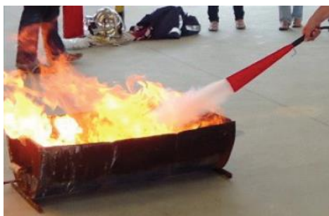
Figura 1.9: Extinção química com extintor halon ou CFC.
