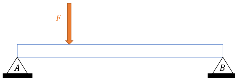
Viga biapoiada com carga concentrada
