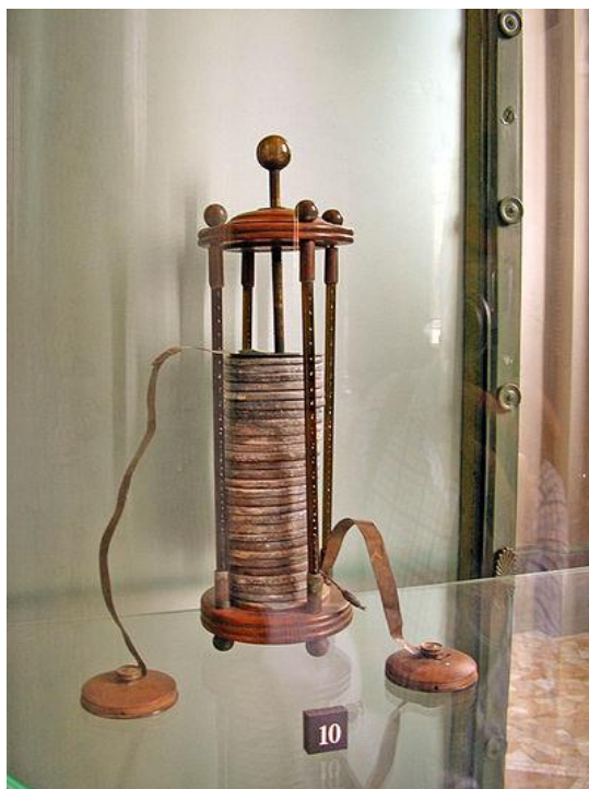
Figura 7 - pilha construída por Volta em exposição no Templo Voltiano, na cidade de Como na Itália [fonte: Wikipedia].
