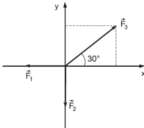
Para que o sistema de forças indicado na figura acima fique em equilíbrio, qual deve ser a razão  $F_1/F_2$ ?
