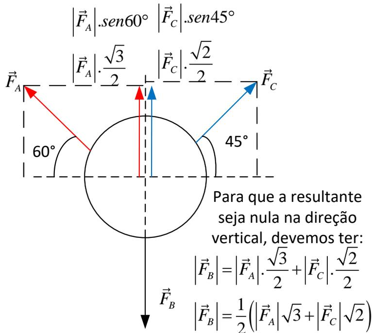
Note que foi feita a decomposição dos vetores  $\vec{F}_A$  e  $\vec{F}_B$ , e depois foi imposta a condição de resultante nula na vertical à roda, que nada mais é do que a força total que puxa a roda para cima deve ser igual à força que puxa a roda para baixo.
