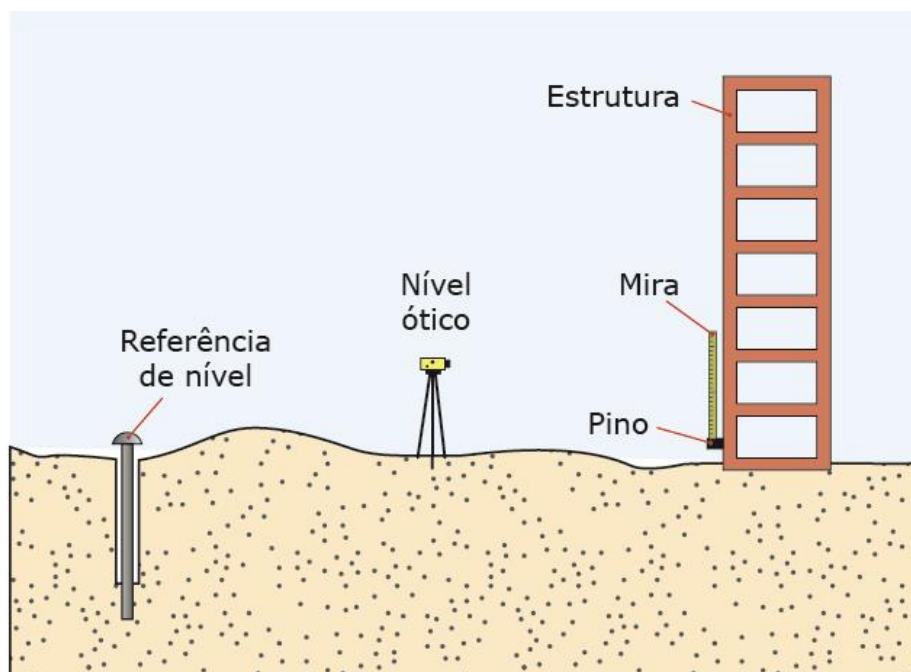
Figura 41: Nível ótico com mira para medição da estrutura
