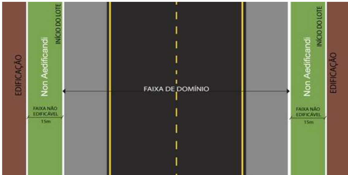
Figura 10 - Partes componentes de uma rodovia
