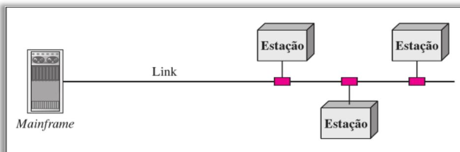
**Já em uma conexão ponto-multiponto, mais de dois dispositivos compartilham um único link.** Em um ambiente multiponto, a capacidade do canal de comunicação é compartilhada, seja de
