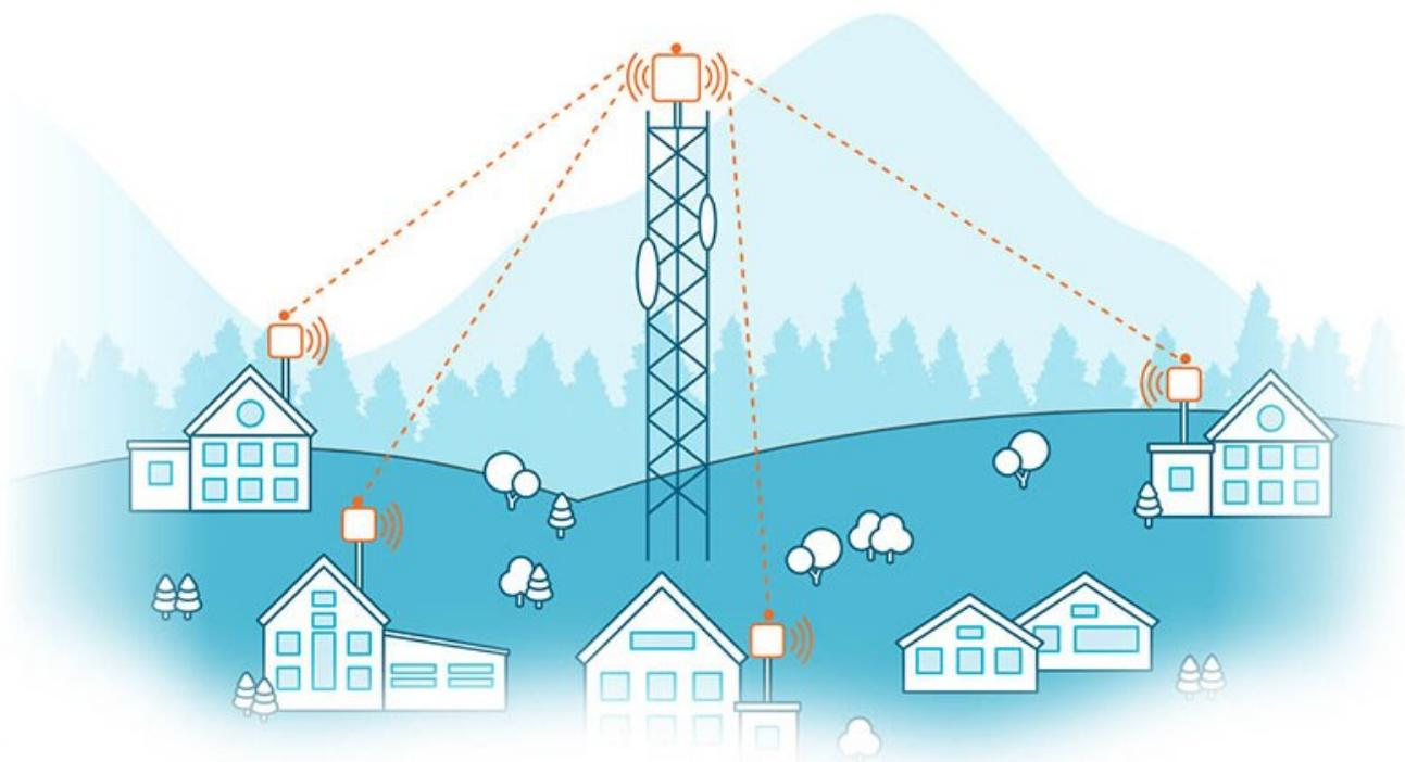
**Trata-se da tecnologia que permite o acesso à internet banda larga via radiofrequência.** As ondas de rádio, em sua maior parte, são omnidirecionais, isto é, quando uma antena transmite ondas de rádio, elas se propagam em todas as direções em broadcast. Elas podem percorrer grandes distâncias e podem atravessar paredes, não necessitando que antenas transmissoras estejam completamente alinhadas.
