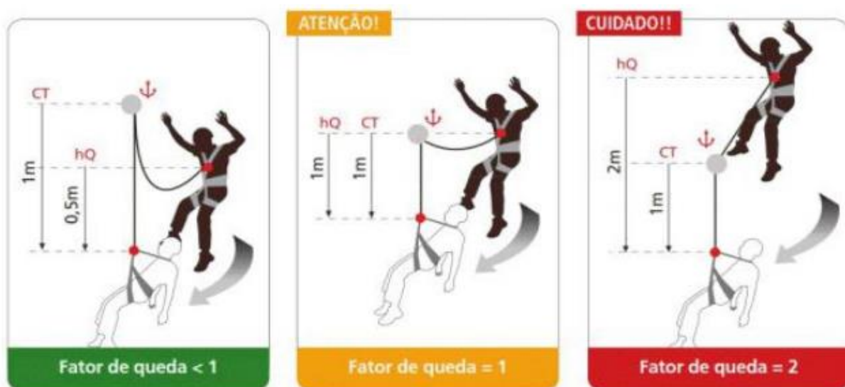
Figura 1.9: (a) ancoragem acima do elemento de engate do cinturão, (b) ancoragem na mesma altura do elemento de engate do cinturão, (c) ancoragem abaixo do elemento de engate do cinturão.
