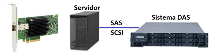
O HBA mostrado acima utiliza Fibre Channel (FC), enquanto um NIC (*Network Interface Card* - uma placa de rede) geralmente utiliza Ethernet.
