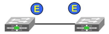
Um ISL Trunk é um ISL lógico que provê uma largura de banda maior, agrupando conexões físicas (de mesma capacidade ou de capacidades diferentes):
