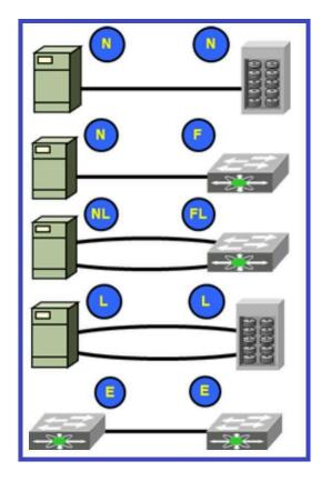
Porta\_N (Porta Nó): utilizada para conectar dispositivos com os *fabric switches* ou com Porta\_N em configurações ponto a ponto.
