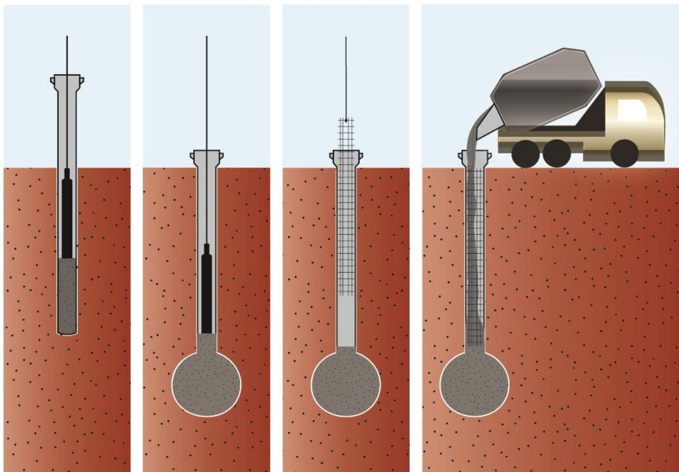
Figura 43: Estaca Franki, observe a ponta alargada
