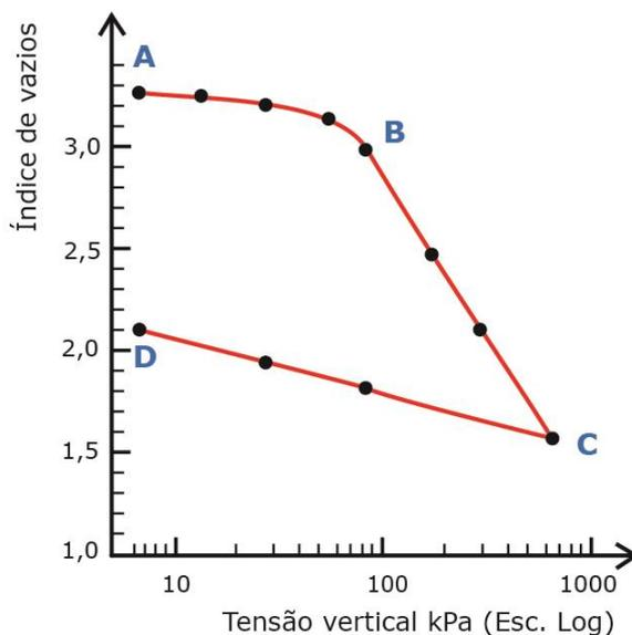
Figura 28: Redução da carga de compressão após adensamento
