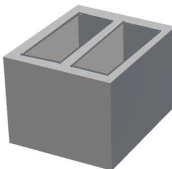
Figura 9: Esquema de fundação profunda do tipo caixão.
