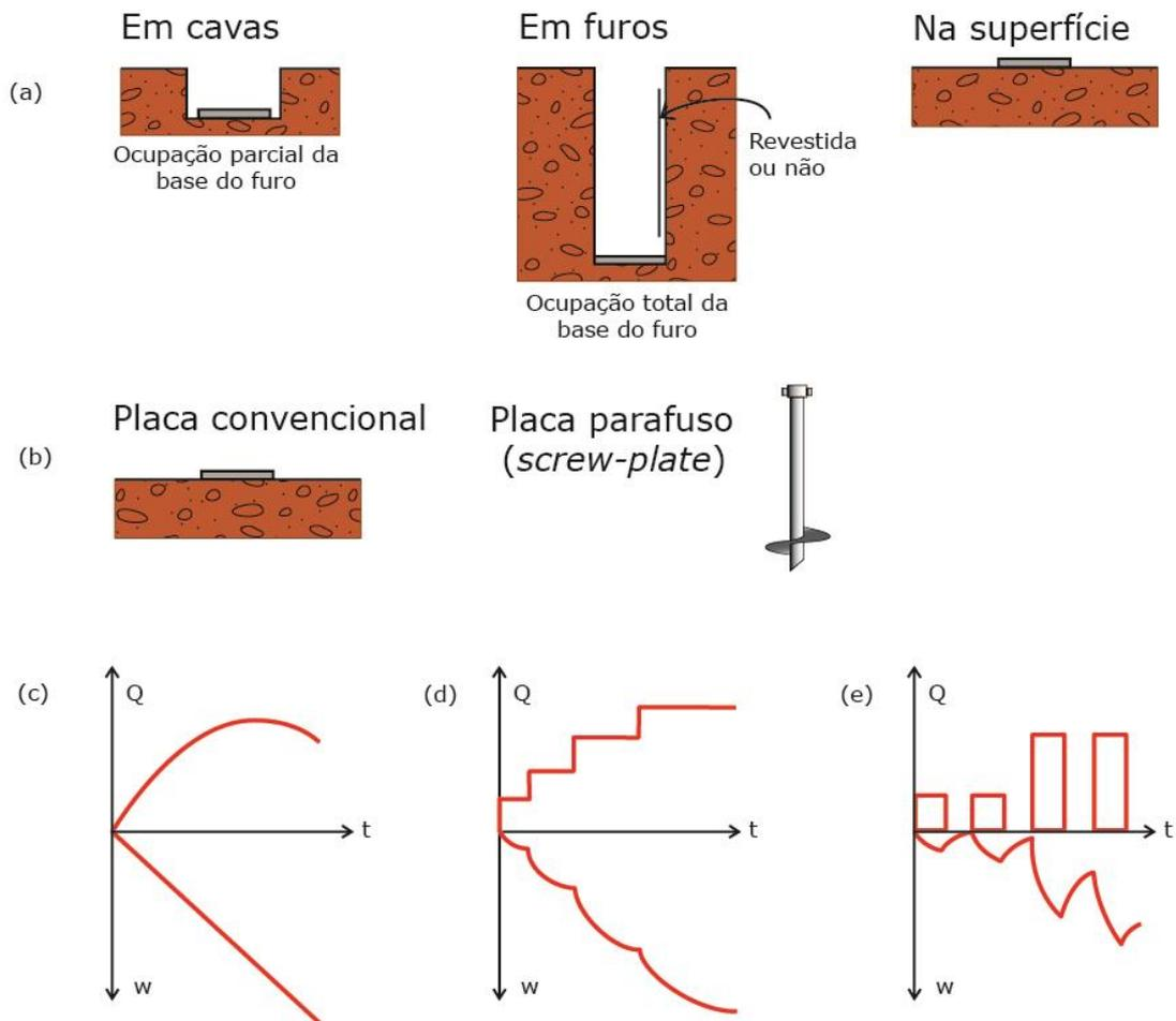
Figura 22: os vários tipos de ensaios de placa
