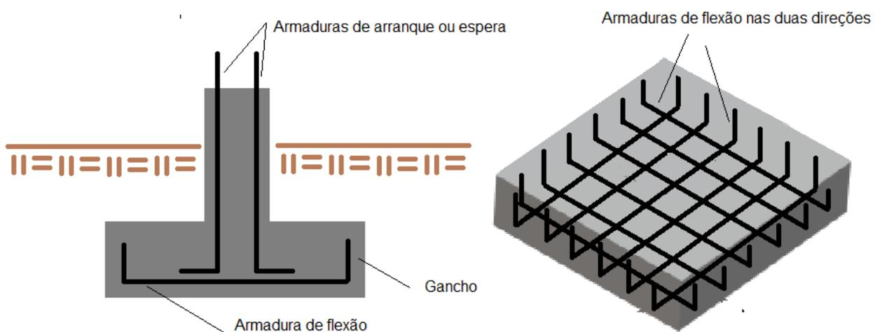
Figura 14: Armaduras de flexão e arranque em sapatas.
