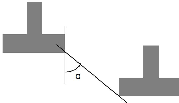
Figura 13: Ângulo vertical entre sapatas em cotas diferentes.
