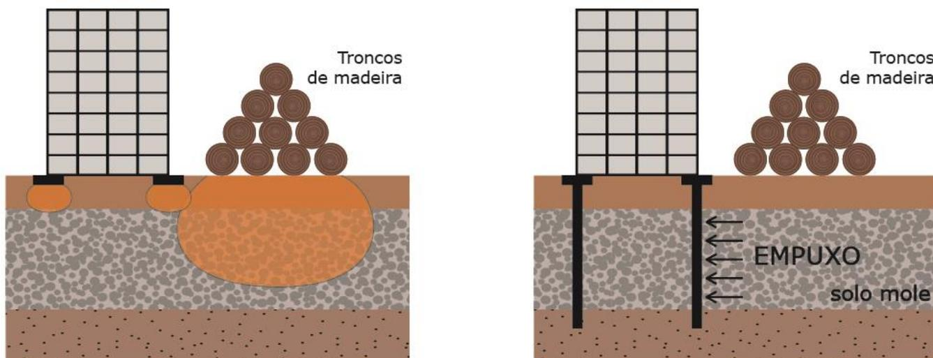
Figura 48: Efeitos de sobrecarga sobre diferentes fundações
