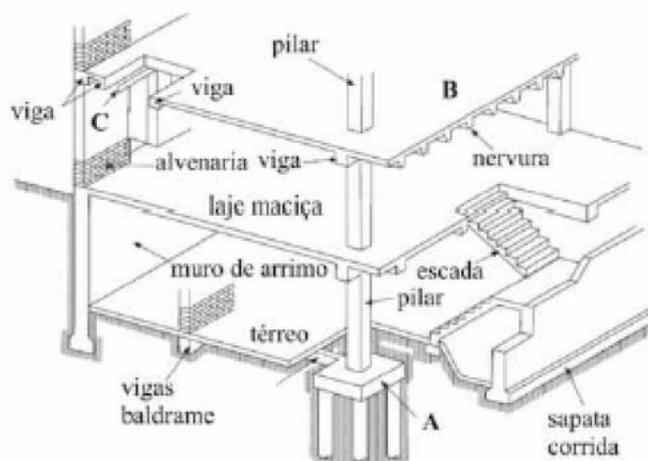
Na figura acima, que representa elementos estruturais de edifícios de concreto, o componente A corresponde a um bloco de alvenaria.
