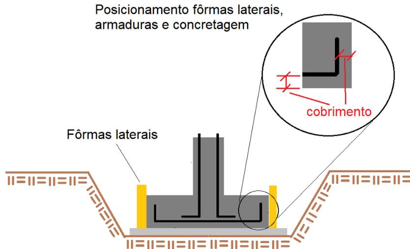
Figura 17: Concretagem da fundação superficial.
