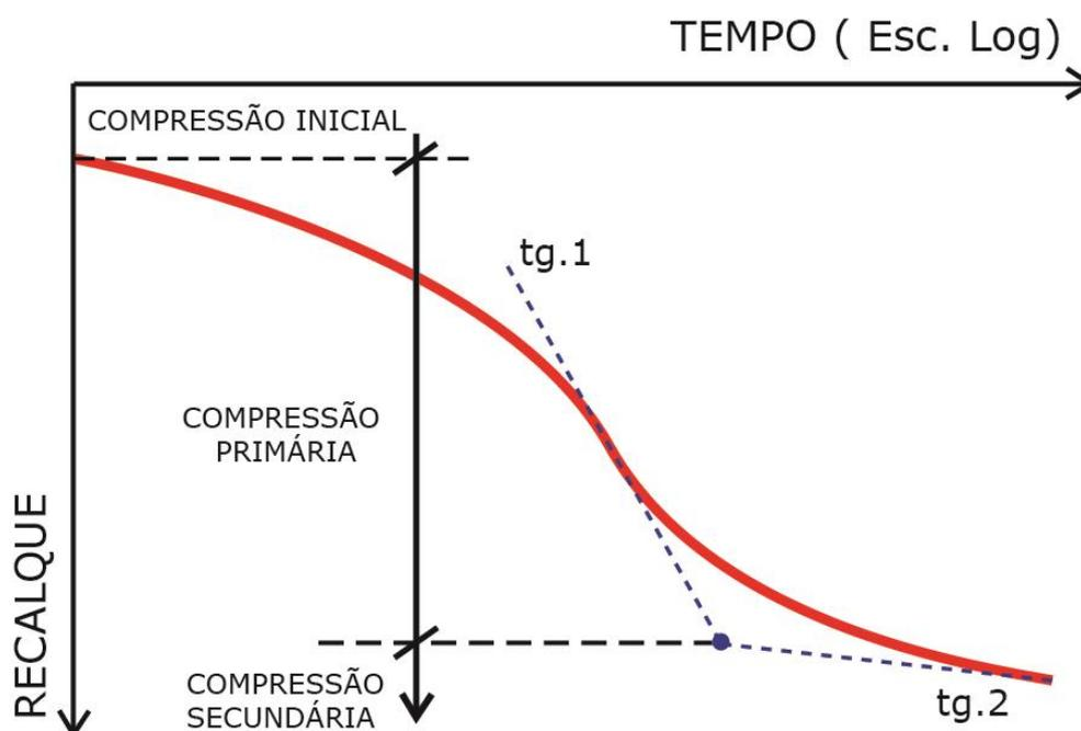
Figura 30: Curva típica de Tempo-recalque em um adensamento
