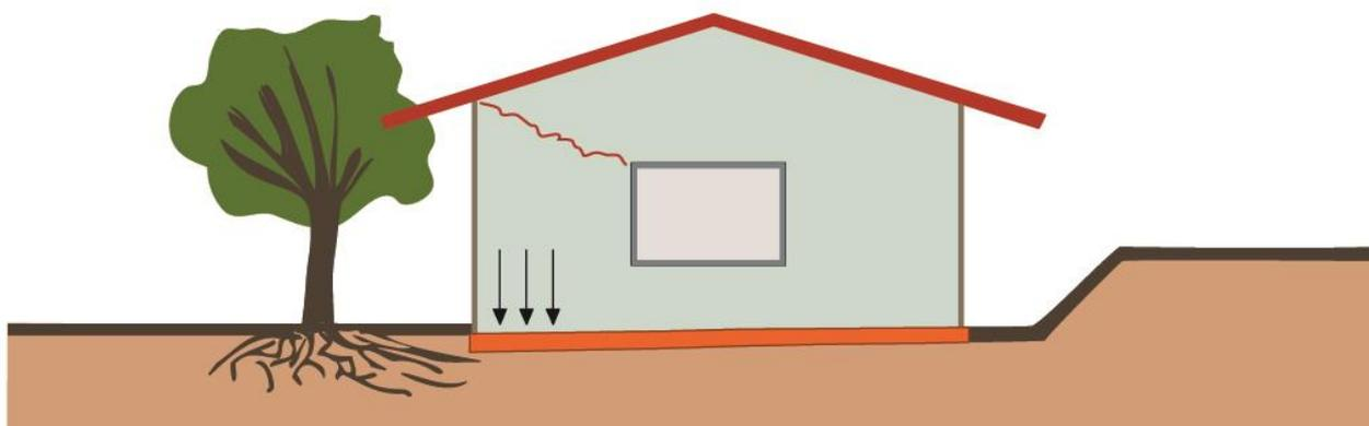
Figura 37: Recalque por solapamento de base de fundação
