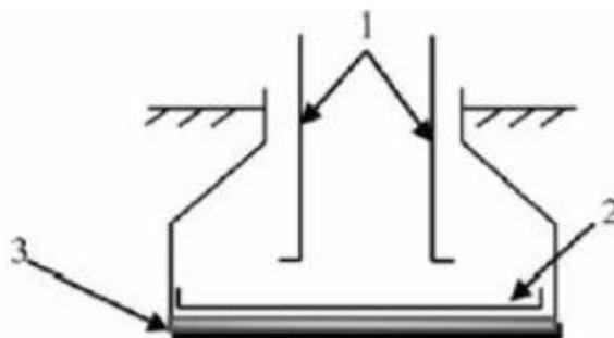
A figura acima ilustra uma sapata de concreto executada na construção de uma edificação, em que as armaduras de aço são indicadas pelos números 1 e 2 e a base de concreto magro, pelo número 3. Considerando essa figura, julgue o item a seguir.
