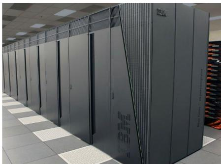
**I. Mainframe:** é um computador de grande porte, que possui alta capacidade de processamento e armazenamento de dados. O termo mainframe era utilizado para se referir ao gabinete principal que alojava a unidade central de processamento nos primeiros computadores. Anteriormente ocupavam um grande espaço e necessitavam de um ambiente especial para seu
