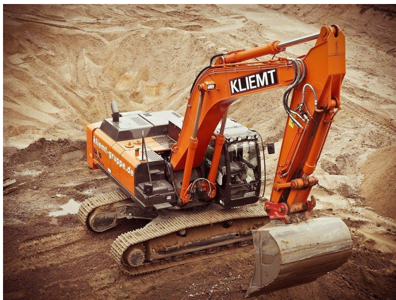
Figura 14: as máquinas autopropelidas devem possuir uma série de dispositivos de conforto ao operador, como cabines fechadas, parabrisa com proteção UV, cortinas, bloqueadores de sol e ar-condicionado
