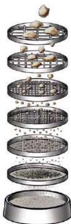
Figura 17: Ensaio de peneiramento
