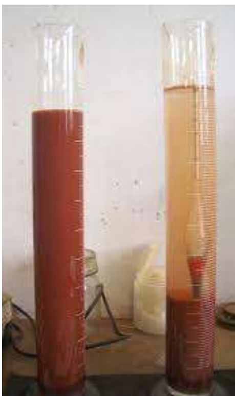
Figura 18 - Proveta com solução contendo fração fina do solo
