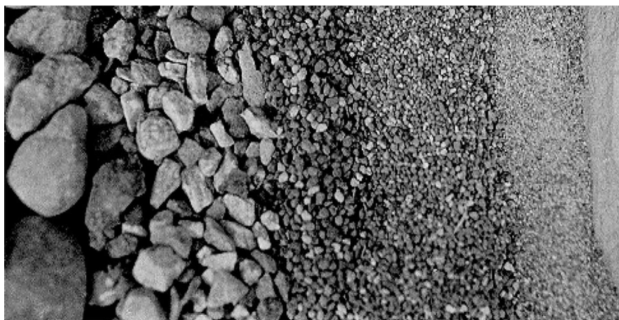
Figura 16: Grãos de amostra de solo segregado por dimensão
