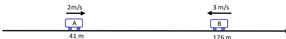
Como o enunciado diz que ambos os móveis estão com velocidade constante, podemos escrever o "Sorvete" (função horária da posição) para cada um. Para o móvel A, usaremos a posição inicial como 41 m ( $S_{0A} = 41m$ ) e a velocidade (positiva) de 2 m/s ( $v_A = 2m/s$ ). Já para o móvel B, usaremos a posição inicial como 126 m ( $S_{0B} = 126m$ ) e a velocidade (negativa) de 3 m/s ( $v_B = -3m/s$ ).
