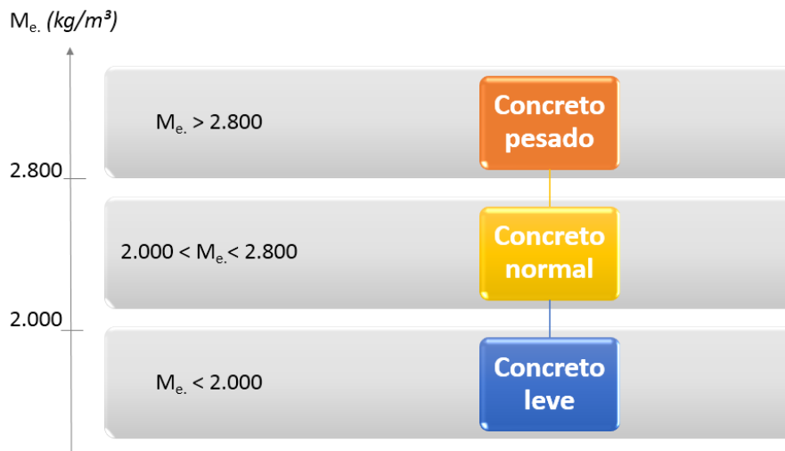
Figura 15: Concretos leve, normal e pesado, com diferentes massa específica seca ( M_e .)
