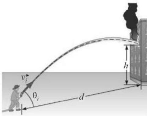
Na figura acima, é mostrada a cena de um bombeiro, que, no plano horizontal, usa um jato de água para apagar o incêndio em um apartamento localizado a  $h$  de altura, em relação ao mesmo plano horizontal. Nessa figura,  $v_i$  é o vetor velocidade do jato de água ao sair da mangueira;  $\theta_i$  é o ângulo de inclinação do bico da mangueira em relação ao plano horizontal; e  $d$  é a distância entre o bombeiro e o edifício.
