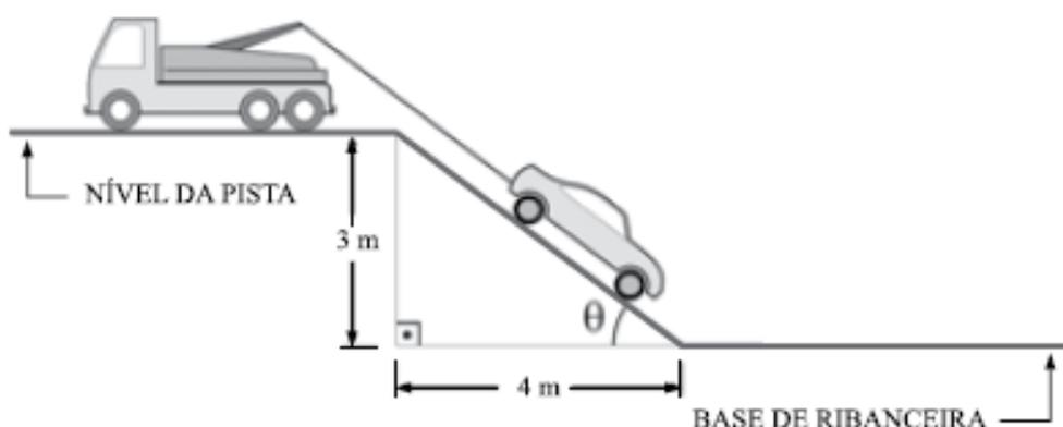
Já com o carro acidentado conectado ao guincho, o perito que acompanhava a retirada do veículo teve sua atenção voltada para um objeto sobre a rampa e, para averiguar, solicitou a interrupção da subida do carro, que já se encontrava a meio caminho da pista. Sendo  $T$  a tração no cabo do guincho,  $N$  a força de reação normal da rampa sobre o carro e  $P$  o peso do carro, a tração imposta ao cabo na situação de equilíbrio tem seu valor calculado por
