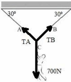
TA é a força Tensão sobre o fio A, TB é a força tensão sobre o fio B e 700N é a força Peso ( $P = m \cdot g = 70 \cdot 10 = 700\text{N}$ ). Fazendo a decomposição de forças, obteremos o diagrama de corpo livre a seguir:
