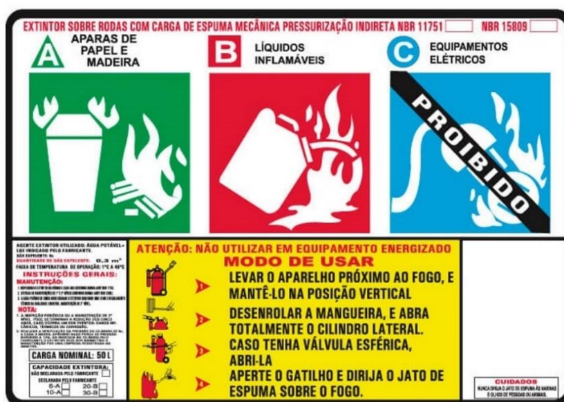
Figura 1.5: instruções de uso para um extintor de espuma mecânica.
