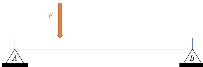
Viga biapoiada com carga concentrada
