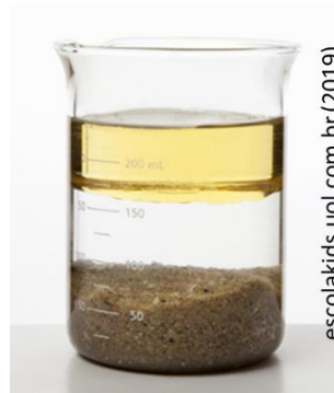
Mistura heterogênea trifásica (sistema trifásico): óleo, água e areia.
