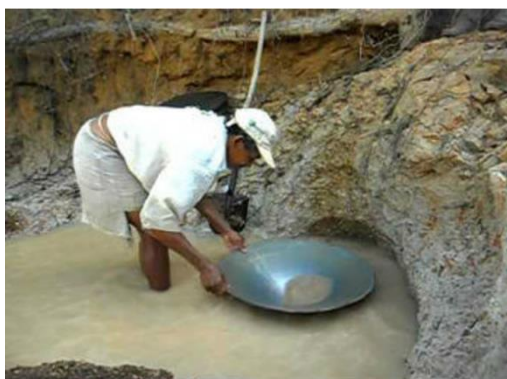
Separação do ouro por meio da levigação
