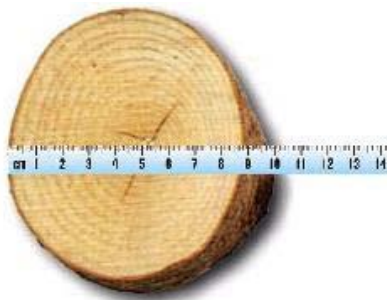
Figura 3 - Uso da régua como na medição de diâmetro.
